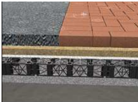
Figuur 7 Schematische dakopbouw met Permavoidsysteem
